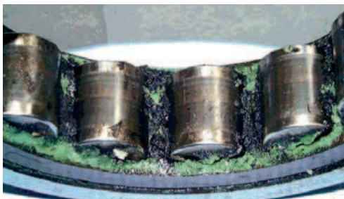
Degradación del lubricante causada por corrientes eléctricas
